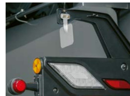
Sensor der automatischen Wurfrichtungsanpassung
