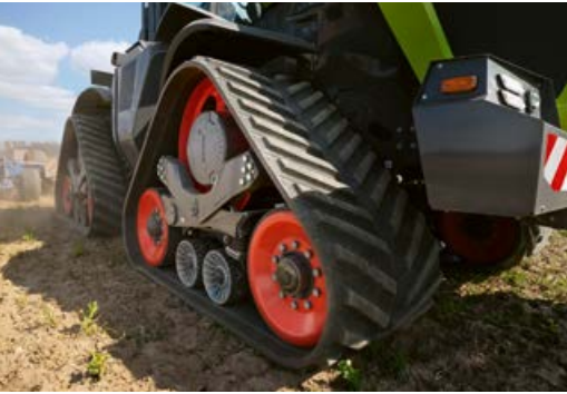
◀ Два варианта ширины гусеничных лент (914 или 762 мм) гарантируют максимально бережное обращение с почвой. С более узкими лентами XERION не выходит за рамки 3 м по ширине.
