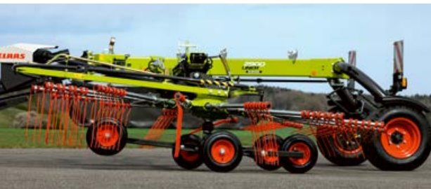
Effetto JET: durante il sollevamento o l'abbassamento la girante si comporta come un aereo in fase di decollo o atterraggio.
