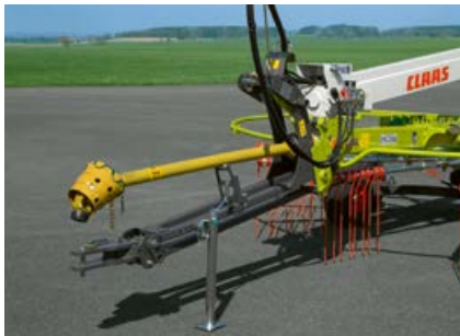
Timone a parallelogramma a richiesta per i LINER 700 TWIN, di serie per i LINER 800 TWIN.
