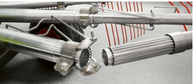
Comodo montaggio e smontaggio dei bracci portadenti: l'attacco brevettato PROFIX con calettatura multipla.
