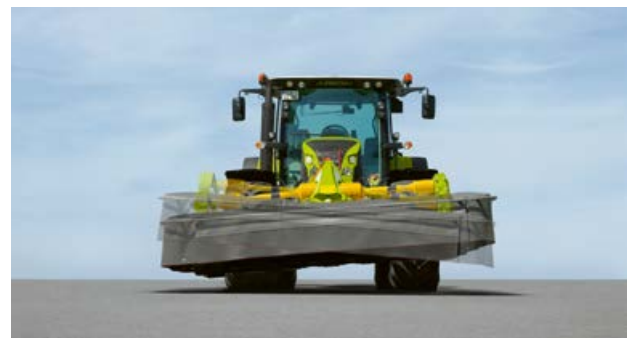
▲ El enganche libremente pivotante compensa irregularidades transversalmente a la dirección de avance.
