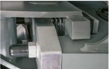
Gummidämpfer im Knickpendelgelenk erhöhen den Arbeitskomfort.
