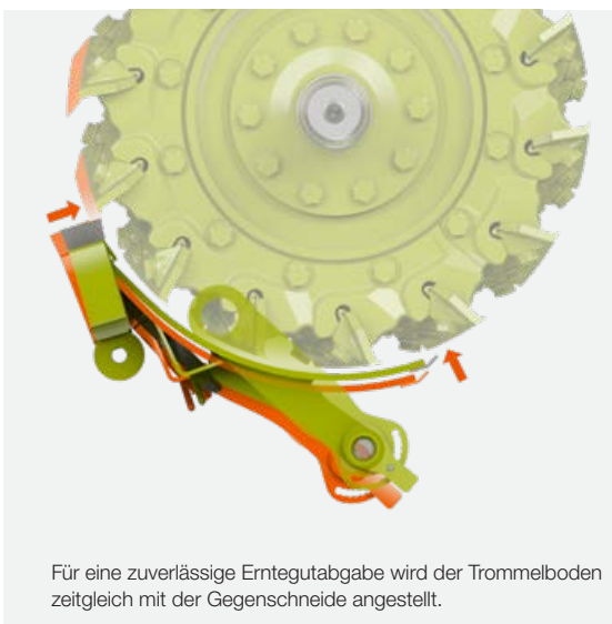
Ein Grundkörper für den flexiblen Aufbau unterschiedlicher Messerkonfigurationen, Segmentringe in hochverschleißfester Ausführung.
