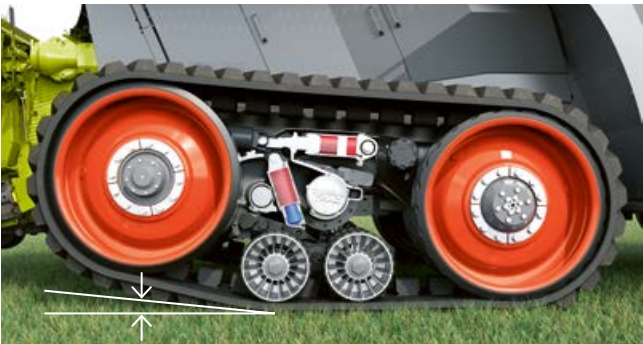
66% Aufstandsfläche: Die Laufrolle wird bei Kurvenfahrten angehoben.
