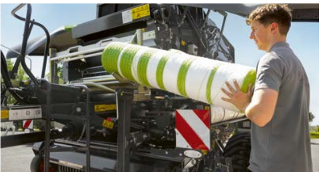
La nuova legatura a rete della serie VARIANT 500 è posizionata più in basso di 25 cm per poter pulire facilmente la bobina di rete sotto il freno della rete.
