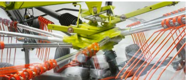
Kardanowe zawieszenie wirników: wirniki dostosowują się do konturów gleby – niezależnie od ciągnika.
