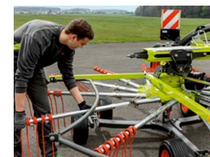
Zabezpieczenie dźwigarów zębów PROFIX
