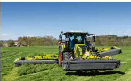
De compacte ophanging zorgt voor een grote bodemvrijheid op de kopakker.
