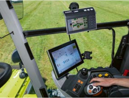
Confort de commande, par exemple avec les différents terminaux ISOBUS et les touches de fonction ISOBUS du levier d'avancement
