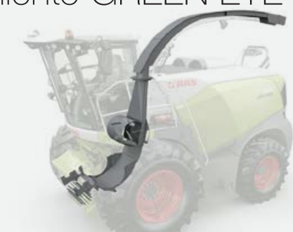
Flujo de material PREMIUM LINE con contracuchilla
