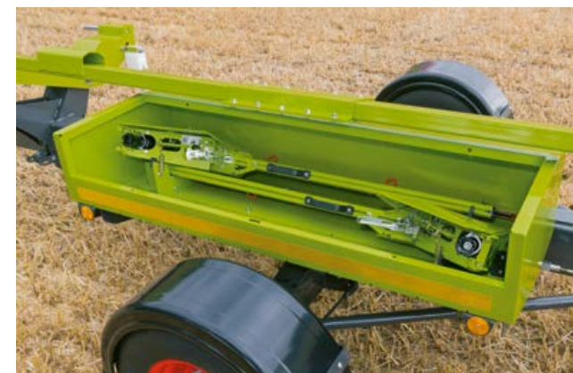
Для безопасного размещения ножей для рапса все транспортные тележки оснащаются запираемым ящиком.
