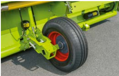
Стабилизирующие колеса обеспечивают плавное ведение жатки в любых условиях.
