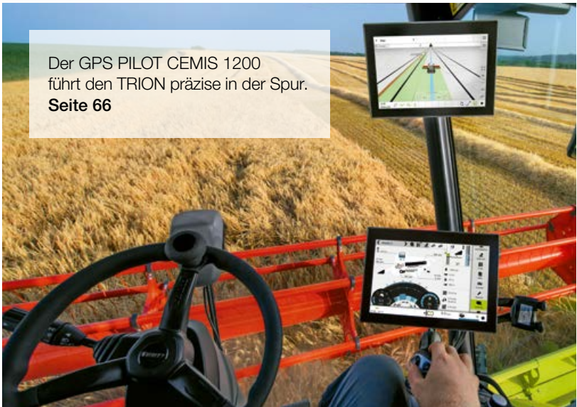
CEMOS AUTO HEADER regelt aktiv die Position der Haspel und des VARIO Schneidwerk-tischs. Seite 63
