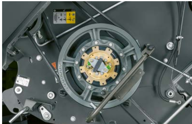
Die Drehzahl des Strohhackslers lässt sich einfach, schnell und werkzeuglos Ihrem Einsatz anpassen.
