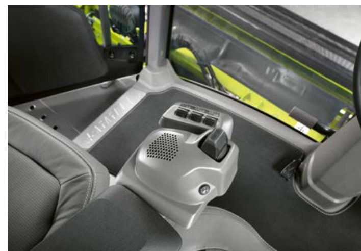
▲ Manœuvres simples et confortables : la direction par joystick et les touches de fonction programmables sont disposées de façon ergonomique sur l'accoudoir gauche. Page 40
