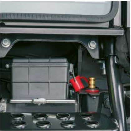
Der ELIOS 3 erleichtert Ihnen den Alltag mit vielen intelligenten Lösungen wie z.B. versetzten Batteriepolen auf der rechten Kabinenseite.
