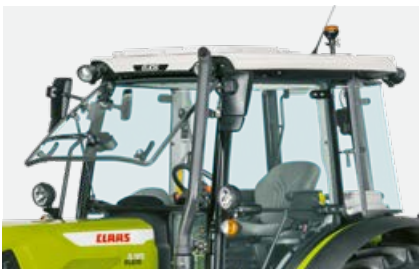
Für eine natürliche Belüftung können Frontscheibe, Heckscheibe und die Seitenscheiben aufgestellt werden.
