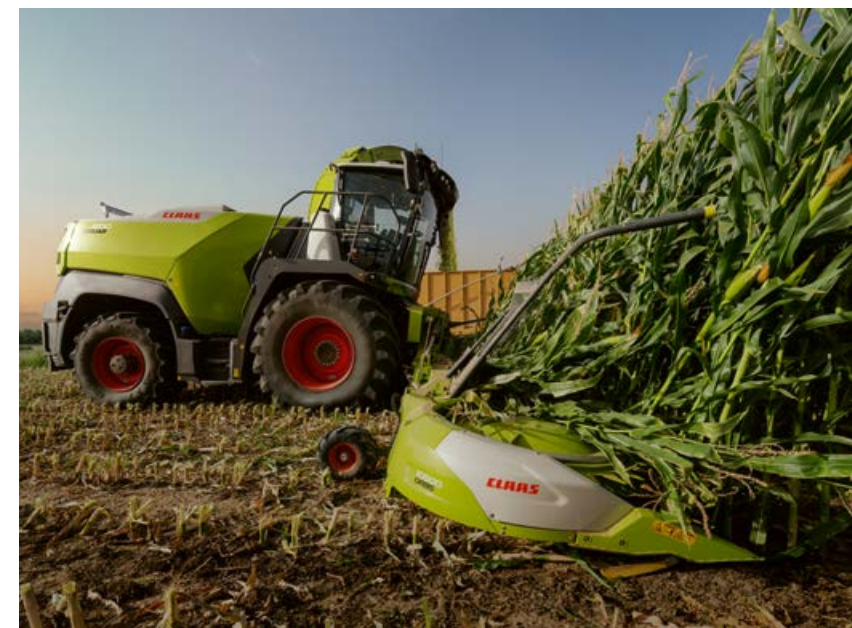
▼ Do długich prac. - Zbiornik paliwa: ogółem 1500 l - Zbiornik mocznika: 145 l - Możliwość stosowania oleju napędowego i HVO
