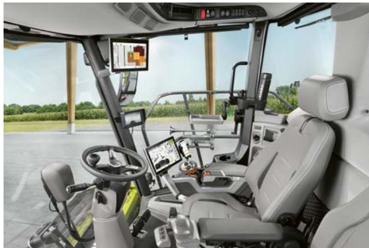
▲ Wysoki komfort, niski poziom hałasu, doskonała widoczność: w przestronnej kabinie zamontowanej na gumowych silentbłokach praca przebiega spokojnie nawet w długie dni. Strona 38
