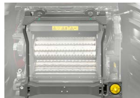
▲ Het zwenkframe zorgt actief (hydraulisch) of passief (zweefstand) voor regelde zijdelingse compensatie om voorzetstukken optimaal op de bodem af te stemmen.
