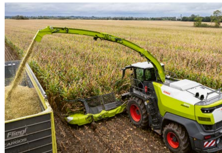
▲ Los cabezales más anchos, como el ORBIS 10500 de 14 hileras, transforman al máximo la potencia de motor instalada en caudal de procesamiento. Página 14
