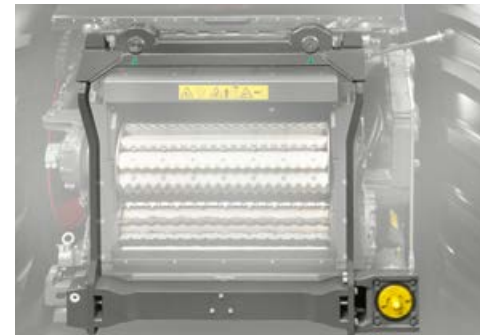
▲ El marco oscilante se encarga de forma activa (hidráulica) o pasiva (posición flotante) de una compensación regulada del desnivel para adaptar los cabezales de forma óptima al suelo.
