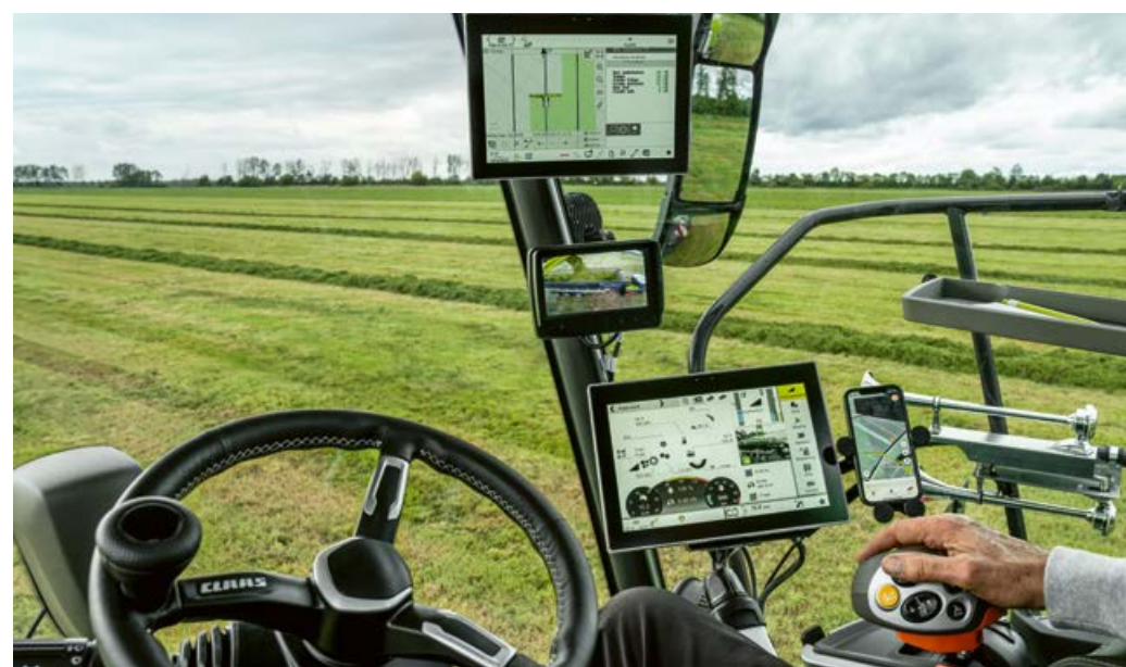
▲ Terminal CEBIS y CEMIS con confortable manejo táctil.
