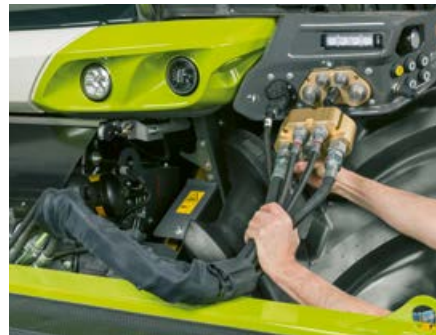
▲ Los acoplamientos múltiples le facilitan la conexión.
