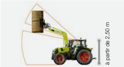
Cabine à toit bas avec toit ouvrant vitré : hauteur de passage à partir de 2,50 m.
