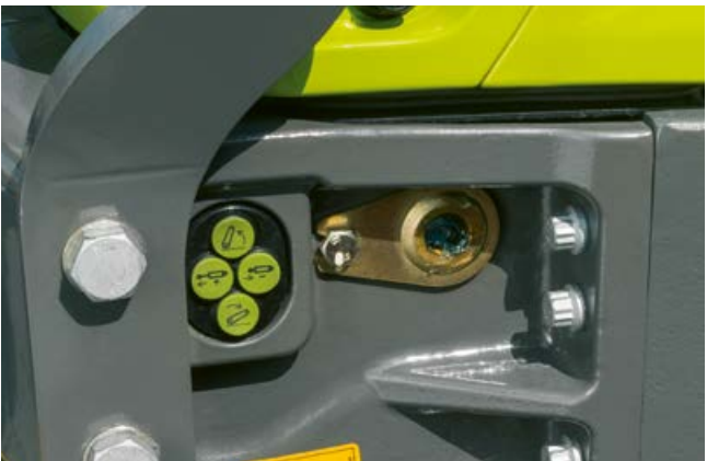
Le relevage avant et le distributeur supplémentaire peuvent également être commandés depuis l'extérieur via les distributeurs électro-hydrauliques.
