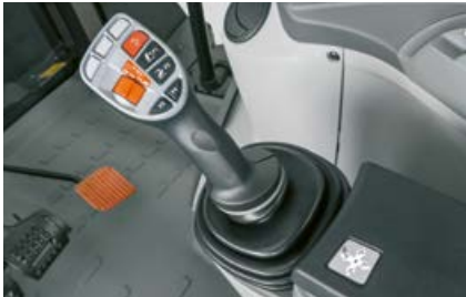
Avec la commande des distributeurs FLEXPLOT, le levier multifonctions reste également parfaitement en main.
