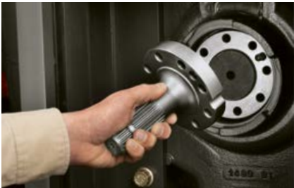
Embout de prise de force facilement interchangeable.
