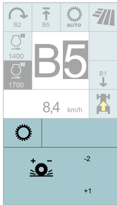
Progressivité de l'inverseur REVERSHIFT avec le CIS.
