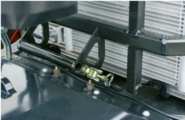
Points de graissage du pont avant installés devant le groupe de radiateurs pour une accessibilité optimale.
