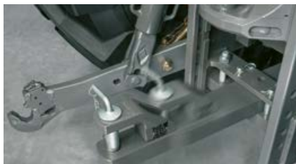
Les modèles de barre oscillante proposent plusieurs positions. La position prolongée permet une maniabilité supérieure.
