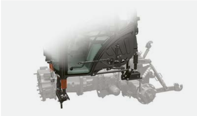
Suspension de la cabine en quatre points.
