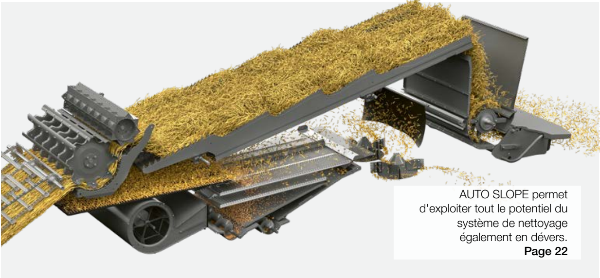
Le segment de contre-batteur interchangeable facilite le passage d'une culture à l'autre. Page 20
