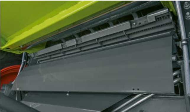
Retrait aisé du segment de contre-batteur à travers le bac à pierres
