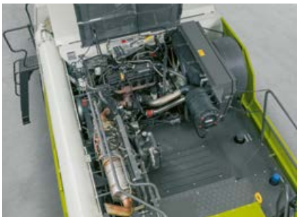
Moteur Cummins avec système de dépollution par injection d'AdBlue (Stage V)
