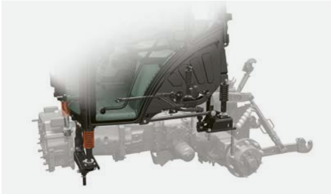
Suspension de la cabine en quatre points.
