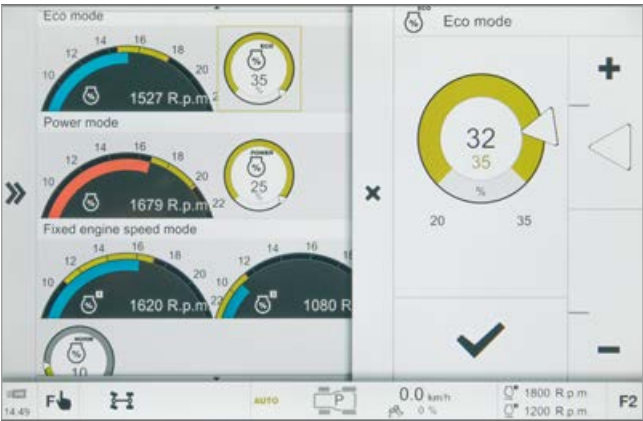
Réglage du droop moteur pour les modes « Eco » et « Power » ainsi que pour la mémoire moteur.
