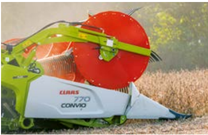
Diviseurs suspendus pour la récolte de cultures à tiges courtes
