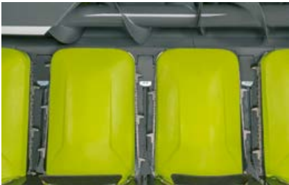
Plaques cueilleuses réglables par commande hydraulique
