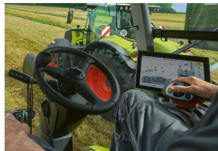
▲ CEMOS mantiene costante il numero di giri impostato e regola la potenza motore e la velocità in base alla quantità di prodotto. CEMOS AUTO CROP FLOW previene i sovraccarichi. Pagina 42
