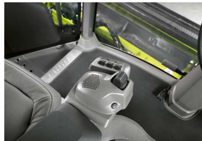
▲ Semplicità e comodità di manovra: il joystick e i tasti funzione liberamente assegnabili si trovano nel bracciolo sinistro. Pagina 40
