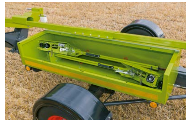
Damit Sie Ihre Rapstrennmesser sicher unterbringen können, sind alle Transportwagen mit einer abschließbaren Transportbox ausgestattet.
