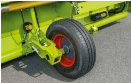
Stabilisierungsräder führen das Schneidwerk ruhig unter allen Bedingungen.
