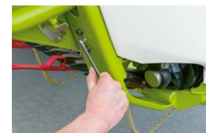
Die Höhe des Halmteilers verstellen Sie einfach mit dem Klappenschlüssel.
