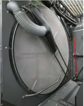
▼ En trabajos de campo y trayectos por carretera, el ventilador de aspiración está permanentemente activo.
