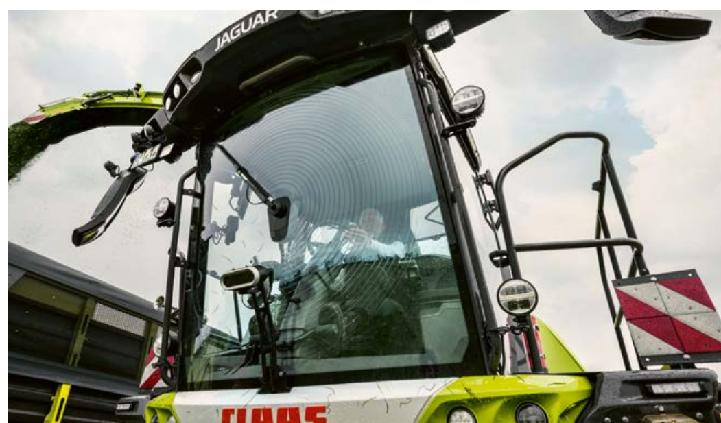
▲ El limpiaparabrisas Premium con salida integrada de agua para el parabrisas delantero ofrece una visión perfecta, también en condiciones de cosecha difíciles.
