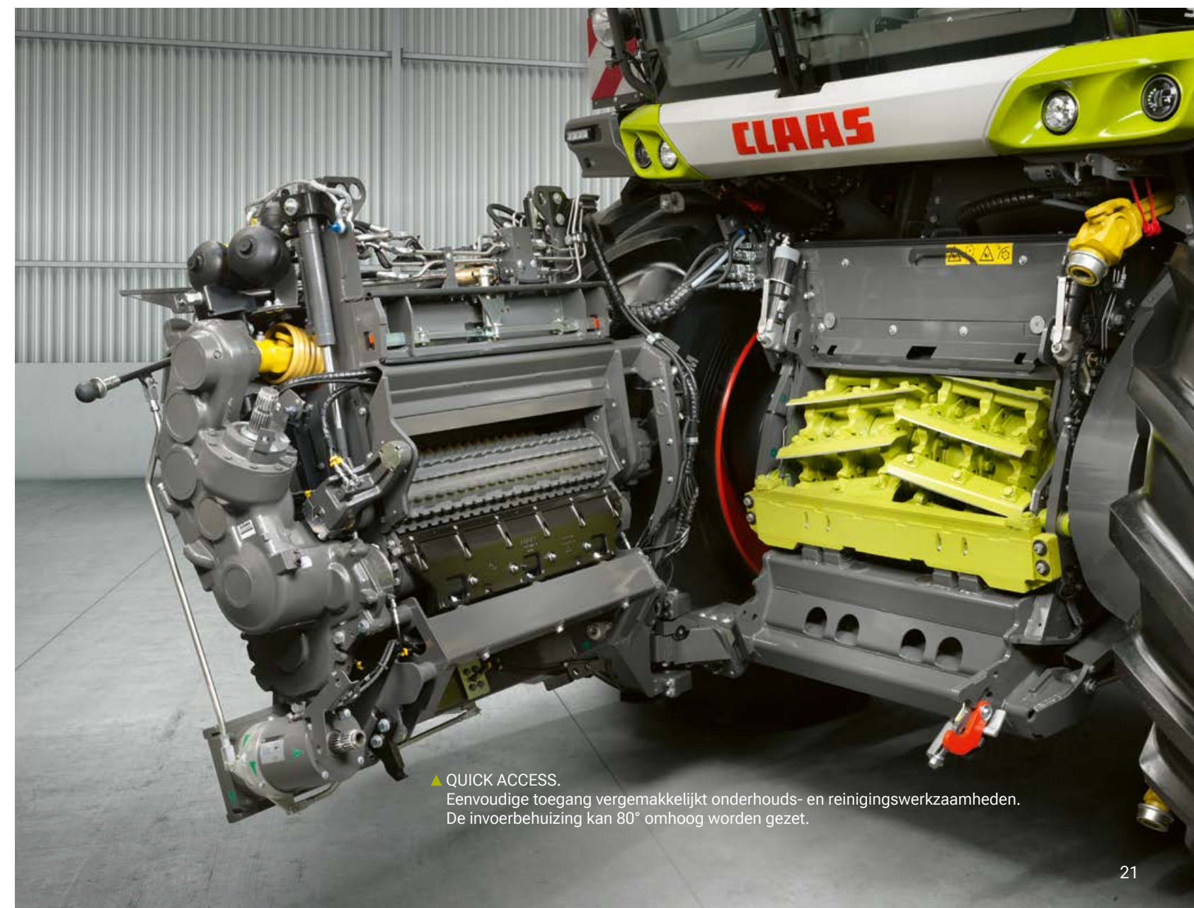
▲ Het zwenkframe zorgt actief (hydraulisch) of passief (zweefstand) voor regelde zijdelingse compensatie om voorzetstukken optimaal op de bodem af te stemmen.
