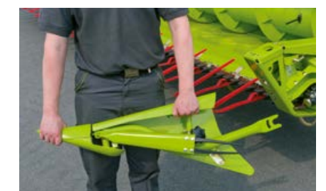
Rozdzielacze łanu można szybko wymienić.
