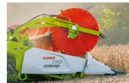
Ułożyskowane sprężynowo rozdzielacze łąnu do zbioru niskich roślin
