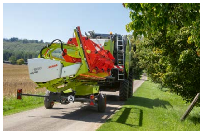
Również z dołączonymi kosami do rzepaku przyrządy żniwne VARIO są kompaktowe podczas jazdy po drogach.
