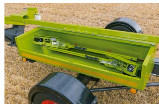
Aby bezpiecznie przechowywać kosy do rzepaku, wszystkie wózki transportowe wyposażono w zamykaną skrzynię.
