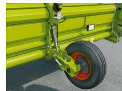
Dwa koła stabilizujące dla lepszego prowadzenia po podłożu
