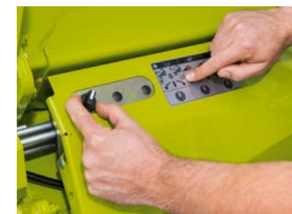
Ustawianie pozycji parkowania i pozycji do czyszczenia odbywa się bezpośrednio na przyrządzie żniwnym
