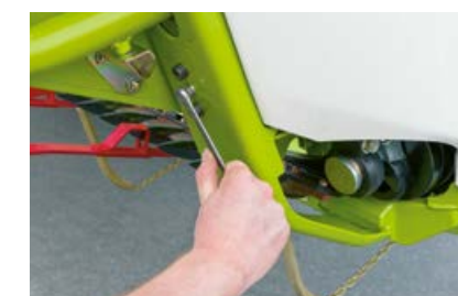
Wysokość rozdzielacza łanu można łatwo zmieniać składanym kluczem.
