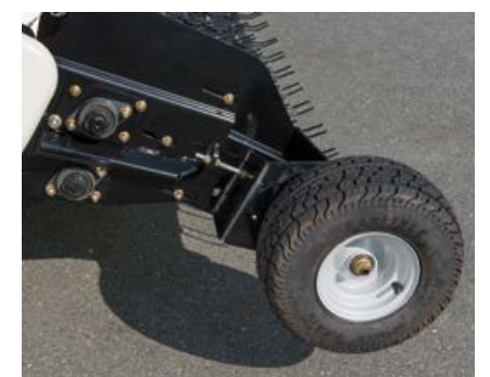
Głębokość roboczą kół kopiujących można ustawić.
