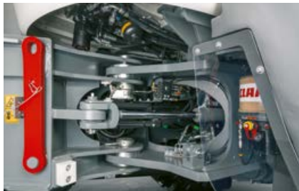
Il giunto articolato con angolo di ribaltamento di 40° rende la TORION agile e maneggevole.
