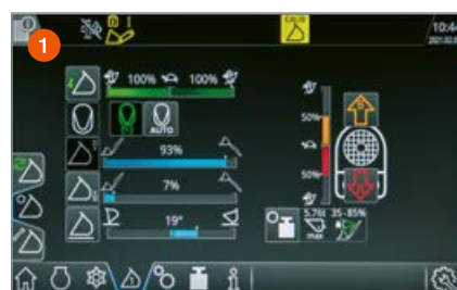
La limitazione dell'altezza di sollevamento e abbassamento memorizza la posizione vicino al suolo e l'altezza di svuotamento ideali.
