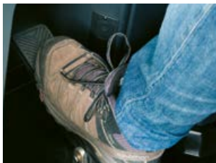
Pedale del freno con funzione marcia lenta.
