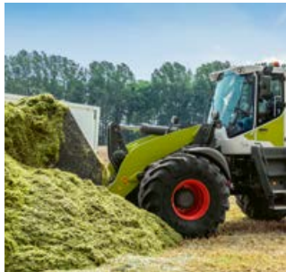
La velocità di svuotamento ridotta protegge i componenti sul braccio di sollevamento.
