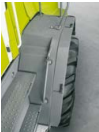
We wszystkich modelach TORION z serii średniej można zamówić regulowane błotniki, poprawiające widoczność kół zwłaszcza podczas prac przy ściąganiu silosu.
