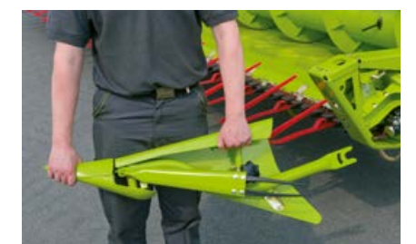
Die Halmteiler lassen sich schnell auswechseln.
