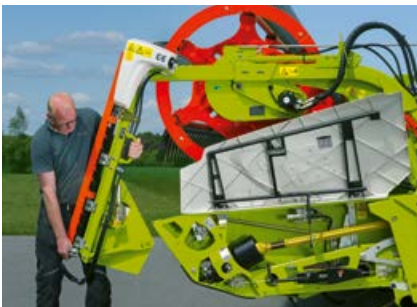
Plug and Play für die Rapsernte. Der Anbau der hydraulisch angetriebenen Rapstrennmesser erfolgt werkzeuglos in wenigen Minuten. Sind die Rapstrennmesser montiert, werden die Zuführschnecken automatisch aktiviert. Damit ist das Schneidwerk bereit für die Rapsernte.
