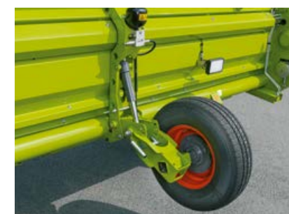
Zwei robuste Stabilisierungsräder für bessere Bodenführung
