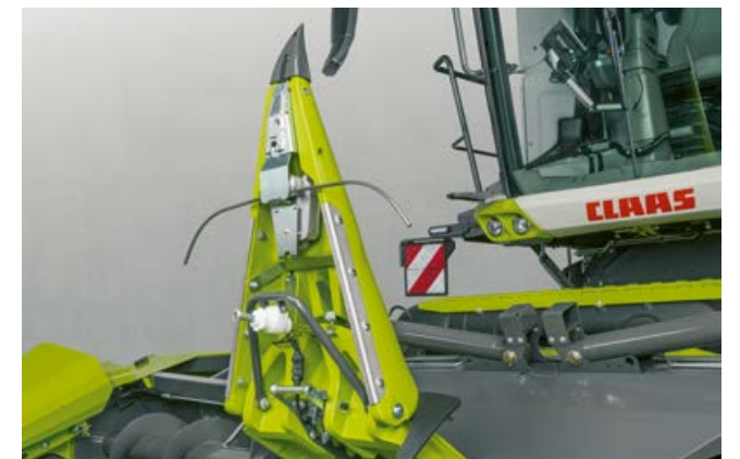
Zwei Tastbügel tasten je eine Maisreihe ab.
