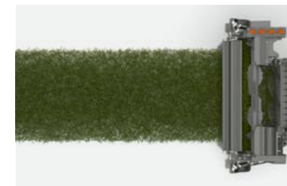
Pickup, PFS und Rollenniederhalter sorgen für einen optimalen Gutfluss.
