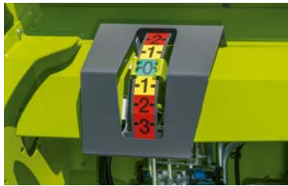
La posición actual de la barra de corte se puede ver muy bien desde la cabina.
