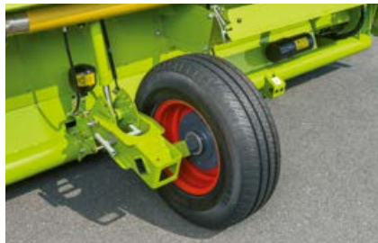
Ruedas estabilizadoras llevan el mecanismo de corte suavemente en todas las condiciones.
