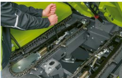
Las cadenas transportadoras puede retensarlas fácilmente.
