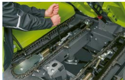
Le catene di trasporto possono essere tese facilmente in qualsiasi momento.
