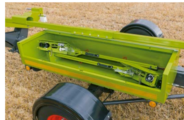
Tutti i carrelli portabarra sono dotati di un box di trasporto munito di serratura, che consente di alloggiare al sicuro le lame taglio per colza.
