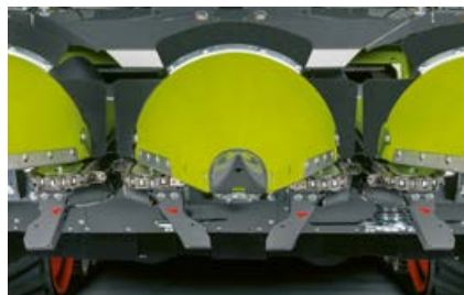
Deflettori in gomma per la presa delle pannocchie favoriscono una raccolta priva di perdite.
