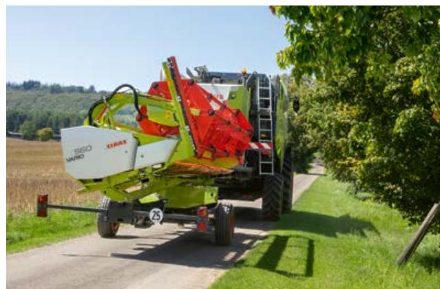
Anche con le lame per colza montate, le piattaforme di taglio VARIO avanzano compatte su strada.
