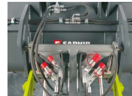
Ritorno senza pressione nella parte anteriore e condotto perdite olio supplementare con innesto sul porta-attrezzi (644 / 537).
