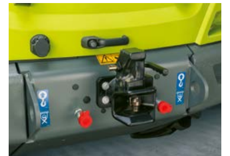
TORION 956 SINUS, a richiesta con ritorno idraulico senza pressione nella parte posteriore.
