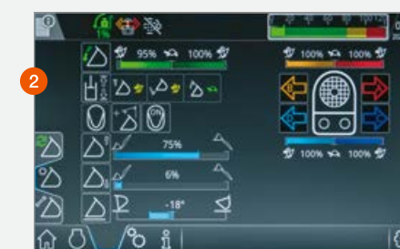
Ustawienia wysokości podnoszenia i opuszczania są wyświetlane na 9-calowym ekranie dotykowym.
