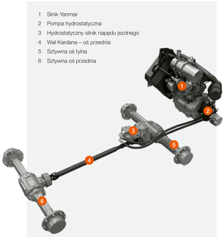
Przekładnia hydrostatyczna z samoczynnym hamowaniem
