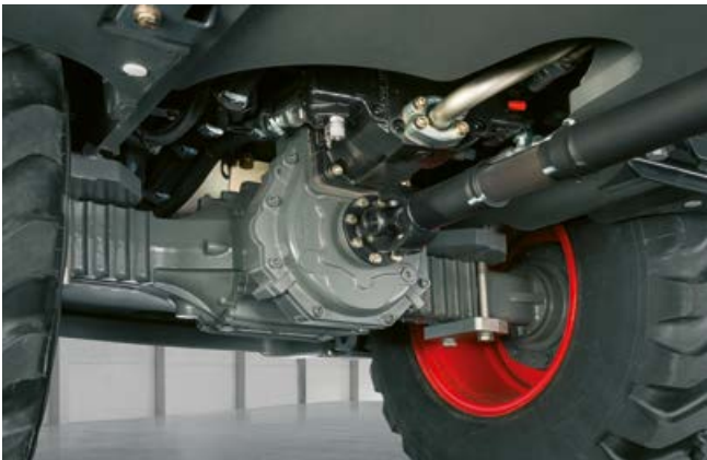
Przekładnia hydrostatyczna z samoczynnym hamowaniem
