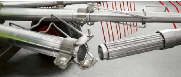
Удобный монтаж и демонтаж граблин: запатентованная система фиксации пальцев PROFIX с многозубчатым зацеплением.
