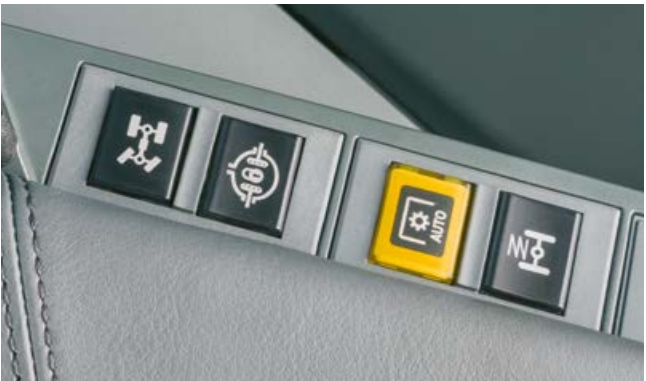
Activación de la suspensión del eje delantero.
