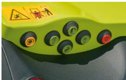
Mando externo para la toma de fuerza trasera en ambos guardabarros.
