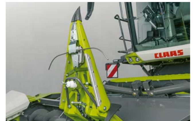
Dos palpadores palpan cada hilera de maíz.
