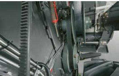
Accionamiento del cilindro de trilla con dos rangos de revoluciones que se pueden ajustar fácilmente.
