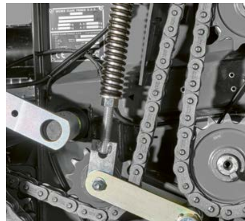
Эффективное устройство для натяжения цепи.
