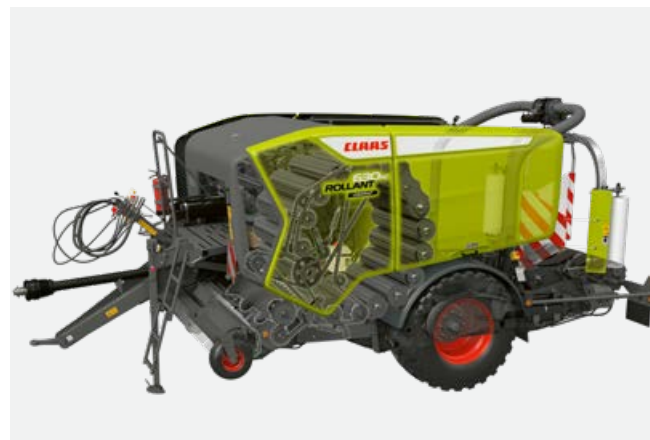
Новая кинематическая схема цепи.
