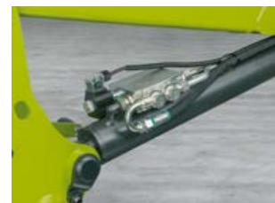
Dzięki elektrycznemu przełączaniu w serii FL i FL C zawory zabezpieczające można połączyć z tłumieniem wstrząsów SHOCK ELIMINATOR.
