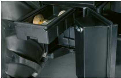
Aan de rechterkant in de opstap bevinden zich de batterij en een opbergvak voor gereedschap.
