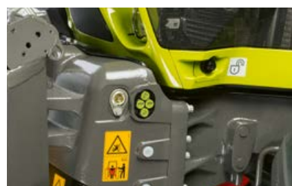
Externe bediening van de fronthef en een regelventiel (alleen met CEBIS).
