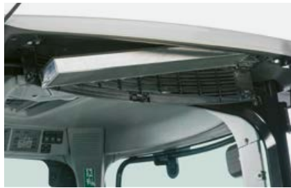
Het luchtfilter in het cabinedak is gemakkelijk bereikbaar.
