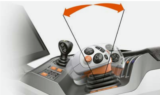
Progressieve bediening dankzij CMATIC traploze transmissietechnologie
