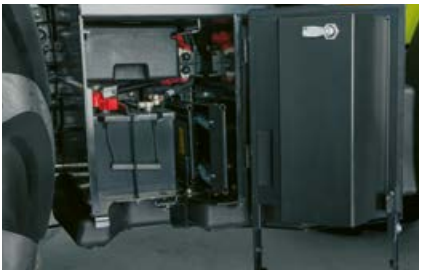
Aan de rechterkant in de opstap bevinden zich de batterij en een opbergvak voor gereedschap.
