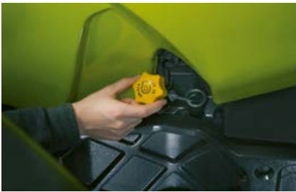
Oliepeil controle en bijvullen zijn mogelijk zonder de motorkap te openen.
