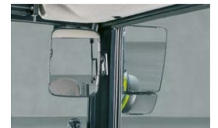
Zusätzlich zum großflächigen Spiegel ist ein Weitwinkelspiegel für mehr Sicherheit im Straßenverkehr verfügbar.
