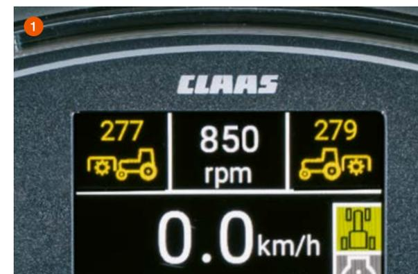
1 Dank der digitalen Drehzahlanzeige für Front- und Heckzapfwelle arbeiten Sie immer mit der passenden Drehzahl.
