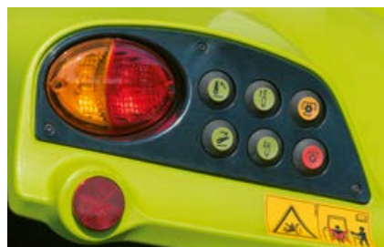
Tagarippsüsteemi, elektroonilist hüdrojagajat ja jõuvõtuvõlli võite juhtida mõlemalt poritiivalt. Vasakul poritiival on hoidik neljale alumise aisa kuulotsale.
