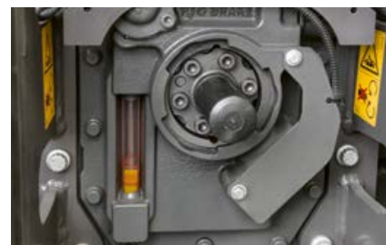
Käigukasti ja hüdraulika õlitaset saate kontrollida läbi vaateklaasi, mis asub jõuvõtuvõlli kõrval.
