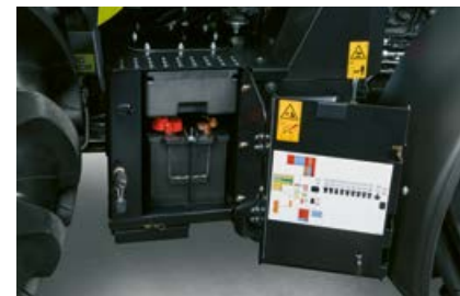
Z prawej strony wejścia, w łatwo dostępnym miejscu znajdują się akumulator, schowek na narzędzia i przyłącze pneumatyczne.
