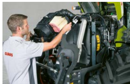
Filtr powietrza silnika jest zamontowany przed chłodnicami i daje się łatwo czyścić.
