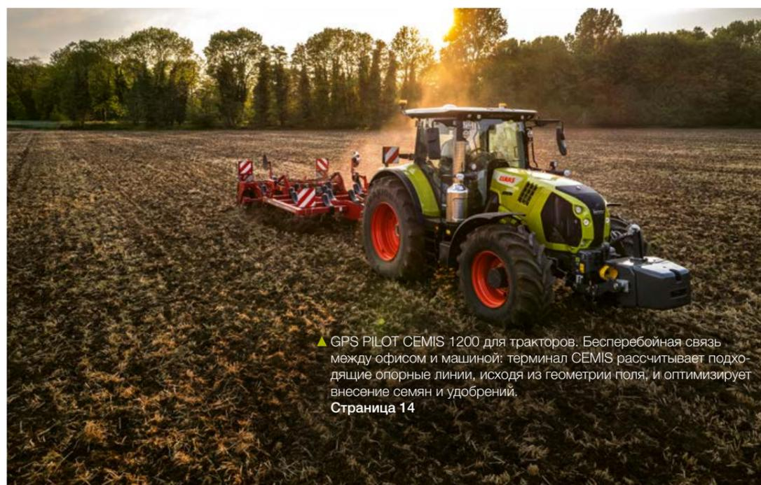
▲ GPS PILOT CEMIS 1200 для тракторов. Бесперебойная связь между офисом и машиной: терминал CEMIS рассчитывает подходящие опорные линии, исходя из геометрии поля, и оптимизирует внесение семян и удобрений.
