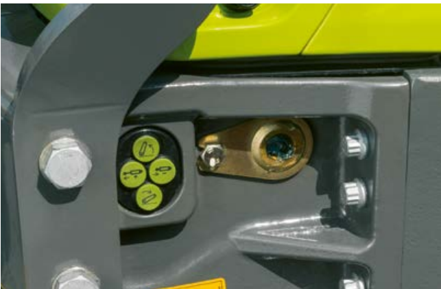
Elektrohidraulikus kihelyezett körök esetén a fűggesztés külső működtetése is lehetséges.
