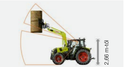
Normál kabin esetén legkisebb traktormagasság: 2,66 méter.
