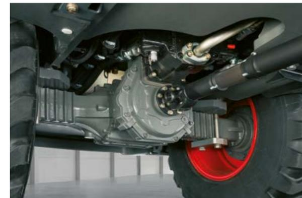
Hydrostatisches Getriebe mit selbsthemmender Bremswirkung
