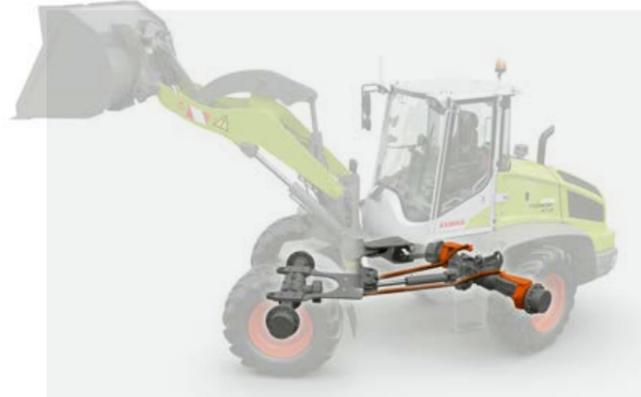
Genau dafür wurde das Fahrwerk des TORION SINUS entwickelt. Die Maschine lenkt nicht nur über das Knickpendelgelenk in der Mitte, sondern auch über die Hinterachse. Zwei Lenkstangen verbinden den Vorderwagen mit den hinteren Achsschenkeln. Sobald Sie den Radlader über das Lenkrad einknicken, lenkt die Hinterachse synchron mit.
