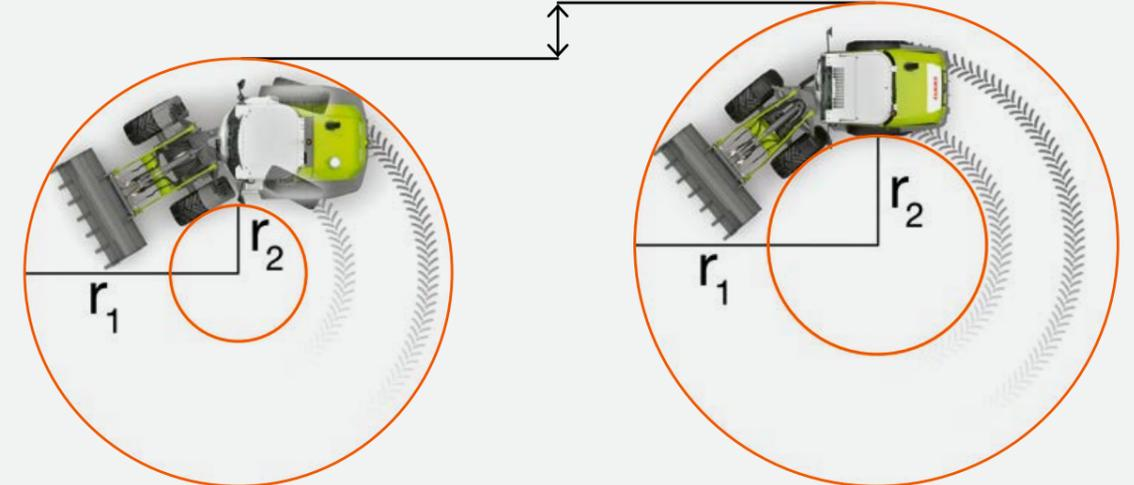
TORION SINUS mit gelenkter Hinterachse
